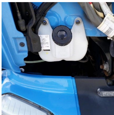
5. Sprinklerbeholder på bil
