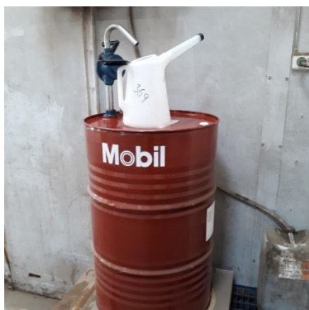
1. Lagerlokation, olietromle med manuel håndpumpe
